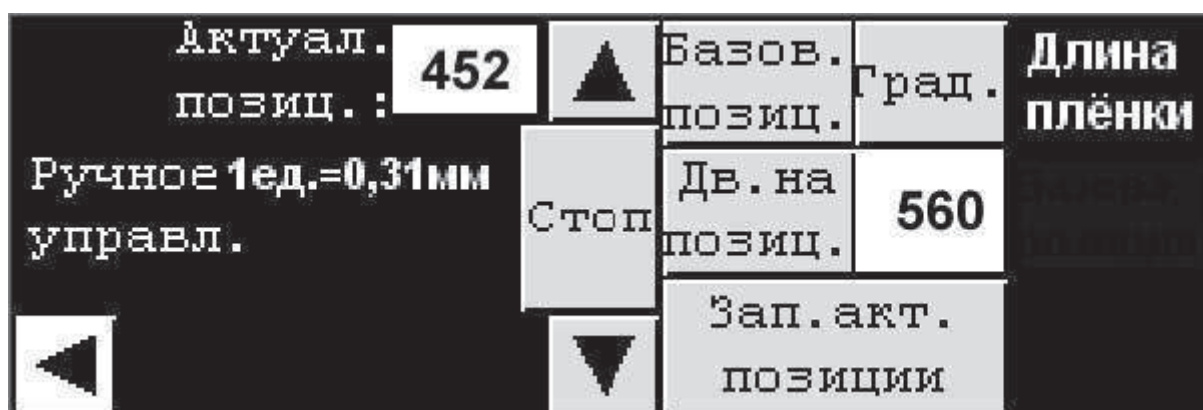
ТР. 20 Кнопки управления узла длины плёнки (опция)
